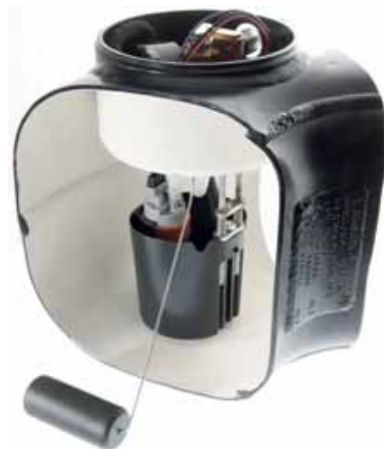
De Fuel Module is gehuisvest in de tank en biedt plaats aan de turbine pomp, de swirl pot, de brandstofniveaubepaler en het longlife filter.
