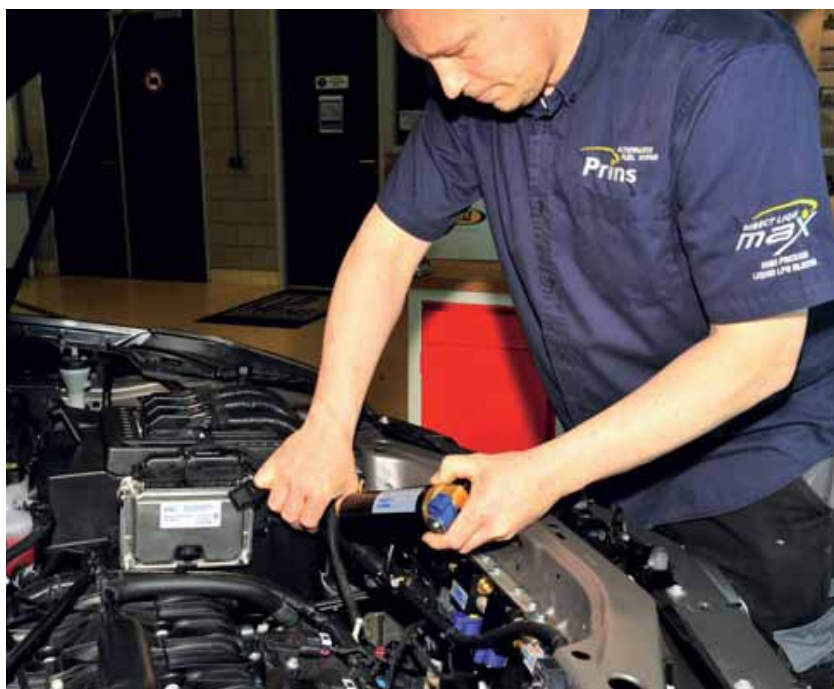
Het Direct LiquiMax LPG-systeem van Prins Autogassystemen maakt gebruik van het bestaande benzine-inspuitsysteem van de DI-benzinemotor. Prins past daarvoor de benzine boost pomp en de retouraansluiting op de hogedrukpomp aan. De LPG-inspuiting is vloeibaar en in de cilinderkop. Het systeem vereist geen verdamper.
